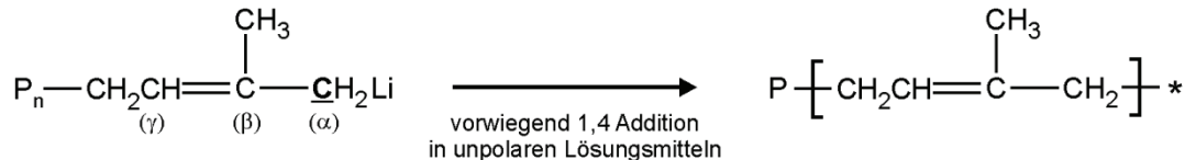
Abb. 15 : Einfluss des unpolaren Lösungsmittels auf die Mikrostruktur von Polyisopren
